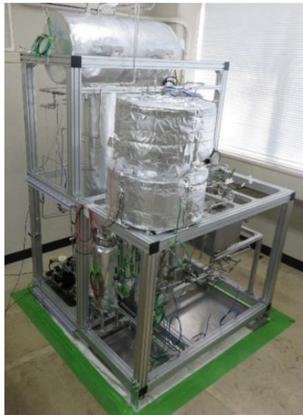
変動再生可能エネルギーの余剰エネルギーの貯蔵、有効利用手段としてケミカルヒートポンプ（CHP）を研究している。CHPは高密度で熱エネルギーが貯蔵でき、電気を使わず熱駆動で昇温（ヒートポンプ操作）ができる。CHP材料として熱・物質移動および反応促進が可能な複合材料を開発し、充填層試験装置（写真）にて実証研究を行い、伝熱解析を進め、スケールアップ・システム検討を進めている。
