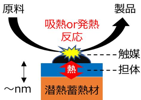
触媒反応の熱制御は、触媒の性能、寿命を左右する重要な技術です。気固触媒反応においては熱交換器を用いたアクティブな制御方式が一般的です。一方、私たちは物質の相変態潜熱を用いて高密度かつ一定温度に熱を制御可能な潜熱蓄熱材を触媒反応デバイスに応用することで、パッシブに触媒反応熱を制御可能な技術を着想しました。コプロダクションやケミカルループ等、その技術基盤の確立を進めています。
